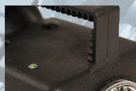
Indicatore LED livello di carica della batteria
